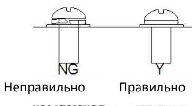
Рис. 5-14 Правильная установка винтов
